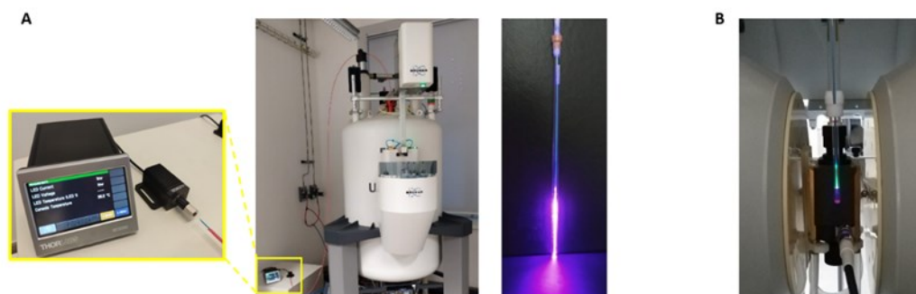
Obr. 1. Aparatura pro in situ ozařování pro měření (A) NMR spekter v roztoku a (B) EPR spekter během kontinuálního ozařování UV/Vis světlem
